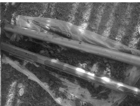
Fig.5 Sapă foraj tubular cu fereastră
